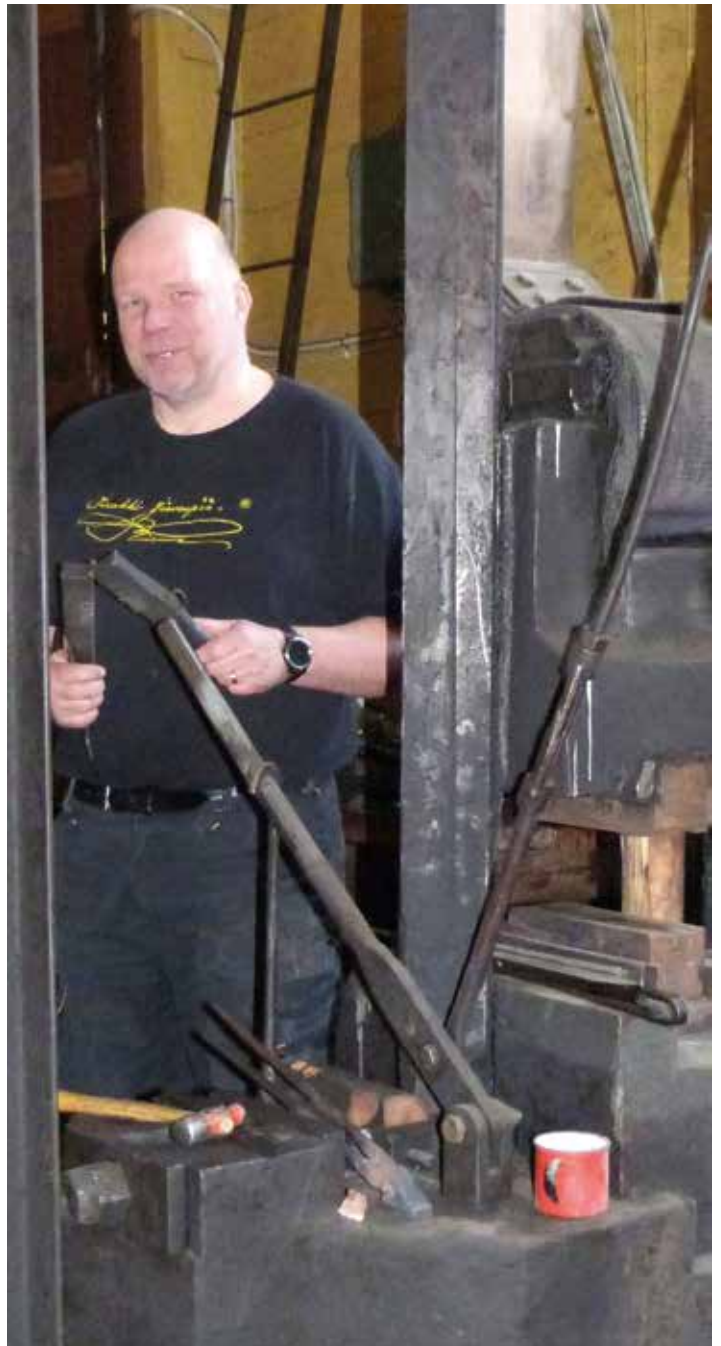
Järvenpään puukot tehdeään edelleen perinteisin menetelmin. Massiivisella pudotusvasaralla taotaan terästä. Pajalla Iisakki Järvenpää Oy:n toimitusjohtaja Jarkko Haukkala. Kuva: Hannele Kihlman
